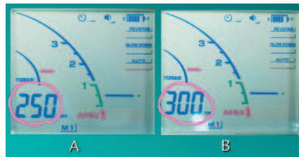
fot. 9 - Wskaźnik prędkości mikrosiłnika A - 250 obr./min. B - 300 obr./min.
