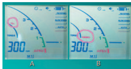
fot. 10 - Kontrola ograniczenia prędkości obrotowej A - Niska wartość ograniczenia B - Wysoka wartość
