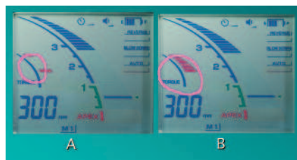
fot. 11 - Odczyt wartości momentu obrotowego A - Małe obciążenie na instrumencie B - Duże obciążenie na instrumencie Wartość pojawia się na wyświetlaczu równocześnie z odczytem pomiaru głębokości kanału.
